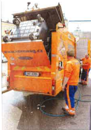
Praktické ukázky si připravila společnost Komwag, která předvedla mimo jiné mycí nástavbu na čištění odpadových nádob
