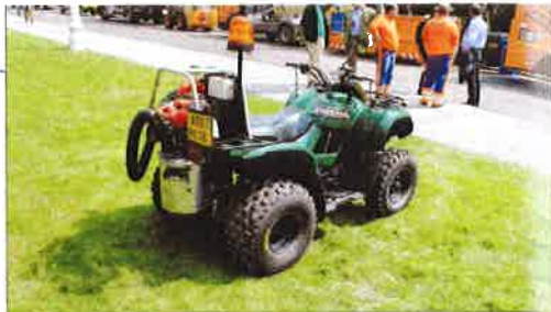
Sběrač psích exkrementů SE 01 na podvozku Yamaha Grizzly s nerezovým zásobníkem s objemem 25 litrů
